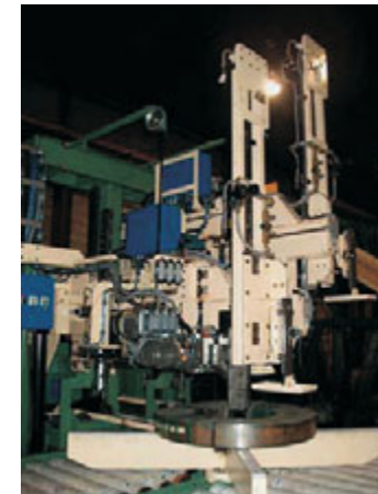
Le dispositif de levage et les tables tournantes empêchent l'endommagement des bords de bobines.
