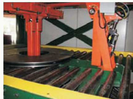
Convoyeur-empileur de centrage des bobines
