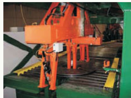
Doigts ramasseurs des diamètres intérieur et extérieur des bobines
